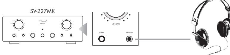
Dadurch werden die Lautsprecher abgeschaltet. Es können alle Kopfhörer mit einer Impedanz zwischen 32 Ohm und 600 Ohm verwendet werden. Ungeeignete Kopfhörer mit zu niedriger Impedanz können den Verstärker beschädigen oder unerwartet eine so hohe Lautstärke produzieren, dass Ihr Gehör geschädigt werden kann. Vor dem Einsticken sollte vorsichtshalber die Lautstärke am Drehknopf bzw. an den Tasten „VOLUME“ (3)(21) reduziert werden.
