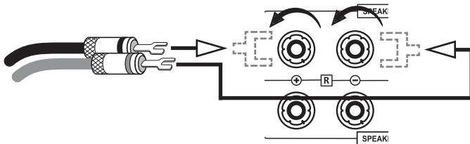
En l'absence de cosse, retirez l'isolant de chaque extrémité du câble sur une longueur d'un cm environ. Torsadez le câble dénudé, pour éviter les court-circuits, desserrez la molette de fixation en la tournant dans le sens antihoraire et insérez l'extrémité du câble dans le perçage dégagé du bornier. Serrez maintenant le câble en faisant tourner la molette de serrage dans le sens horaire. Contrôlez le serrage correct du câble.
