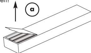
b) Entfernen Sie gegebenenfalls verbrauchte Batterien und legen Sie die neuwertigen Zellen, wie im Batteriefach schematisch dargestellt, richtig ein.
