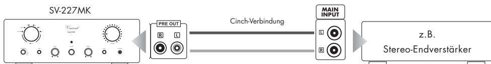
Anstelle des hier gezeigten Stereo-Endverstärkers können ebenso zwei Mono-Endverstärker eingesetzt werden. Das Ausgangssignal ist unabhängig von der Einstellung am Lautsprecherumschalter (4) und dem Einsticken eines Kopfhörers.
