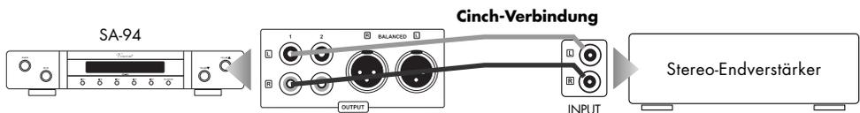
Wenn die Endverstärkerkanäle die Möglichkeit des XLR-Anschlusses bieten, so sollte dieser bevorzugt werden. Verbinden Sie in diesem Fall die mit „BALANCED“ beschrifteten XLR-Anschlüsse (9) mit den Endverstärkereingängen. Achten Sie darauf, dass rechter und linker Kanal nicht vertauscht werden. Die Buchstaben „R“ und „L“ zeigen Ihnen die richtige Zuordnung.
