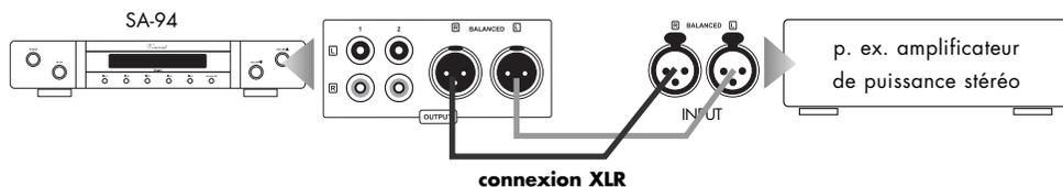
Du fait que le préamplificateur possède deux sorties stéréo de préamplificateur avec la connexion RCA, il est possible de faire fonctionner les haut-parleurs en « Bi-amplification » lors de l'utilisation de haut-parleur adéquat et de canaux d'amplificateurs de puissance suffisant. Votre vendeur spécialisé sera heureux de vous aider pour cela.
