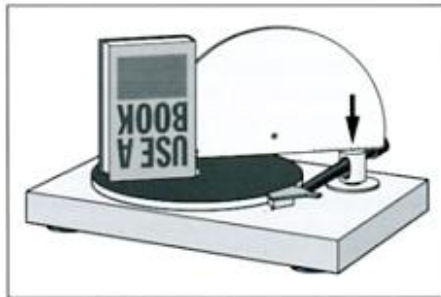
Рис.17: Непрямое измерение навеса тонарма, расположите шаблон таким образом, чтоб точка H находилась на одной линии с осью вращения тонарма, расположите иглодержатель над второй шкалой измерения навеса тонарма. Отметьте положение иглы.
