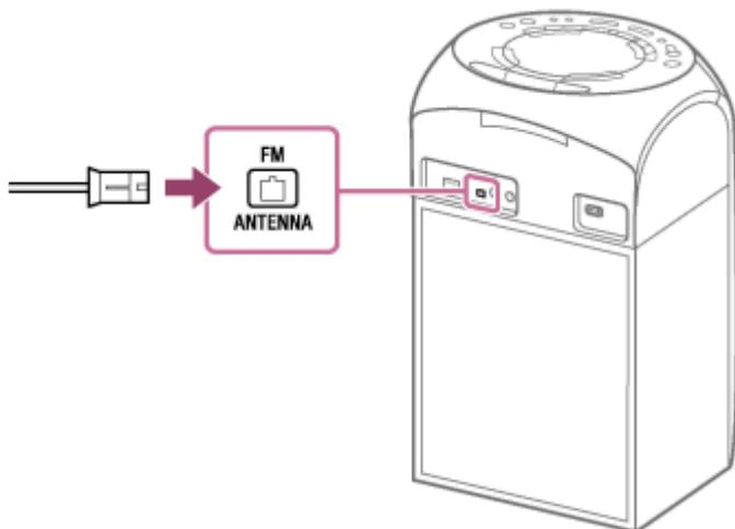
Растяните антенну (наружную) горизонтально. Держите антенну (наружную) подальше от шнура питания переменного тока ( сетевого шнура) и кабеля USB, чтобы избежать возникновения помех.
