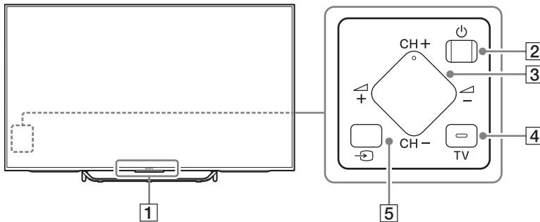
**[1] Датчик пульта дистанционного управления\*<sup>1</sup> / светочувствительный датчик\*<sup>1</sup> / светодиодный индикатор / передатчик Sync 3D-сигнала\*<sup>1,3</sup>**
