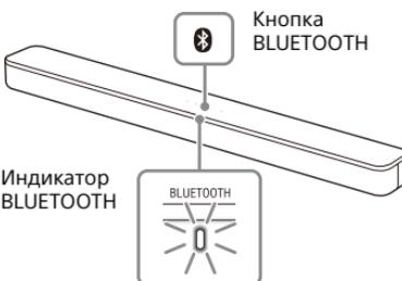
Если сопряжение не выполнено в течение 5 минут после перехода звуковой панели в режим сопряжения, режим сопряжения будет отменен. В этом случае выполните сопряжение сначала.
