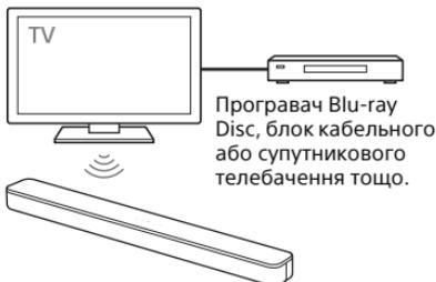
Програвач Blu-ray Disc, блок кабельного або супутникового телебачення тощо.
