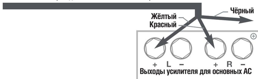
**Примечание:** конструкция сабвуферов REL Серии S позволяет подключать их к цифровым усилителям класса D. При подключении к усилителю класса D следуйте приведённой выше схеме для подключения к дифференциальным усилителям.
