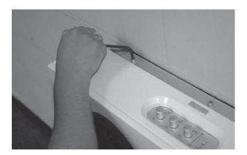
21. Зацепление должно быть прочным. Закрепите сабвуфер с помощью трёх 13.5-мм монтажных винтов. Закрутите три винта, затягивая каждый поочерёдно на пол-оборота. До полного затягивания винтов потребуется несколько проходов. Вы заметите, что с каждым проходом сабвуфер равномерно опускается вниз.
