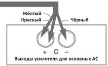
• При подключении Habitat1 в качестве сабвуфера тылового канала соедините чёрный провод сабвуфера с левой или правой отрицательной акустической клеммой тылового канала усилителя; жёлтый провод сабвуфера соедините с левой положительной акустической клеммой тылового канала, а красный — с правой положительной акустической клеммой тылового канала усилителя.
