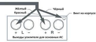
**Примечание:** Habitat1 оснащён внутренней схемой, позволяющей подключать сабвуфер к цифровым усилителям класса D. В этом случае пользуйтесь описанной выше процедурой подключения к дифференциальным усилителям.
