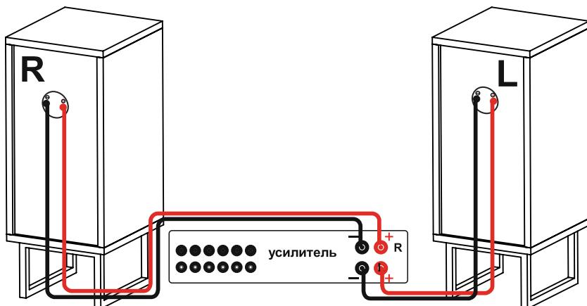
Подключите акустическую систему, встроенную в изделие, в соответствии с представленной выше схемой.
