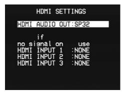
Меню HDMI SETTINGS позволяет определить, как должны обрабатываться аудиоканалы HDMI:
