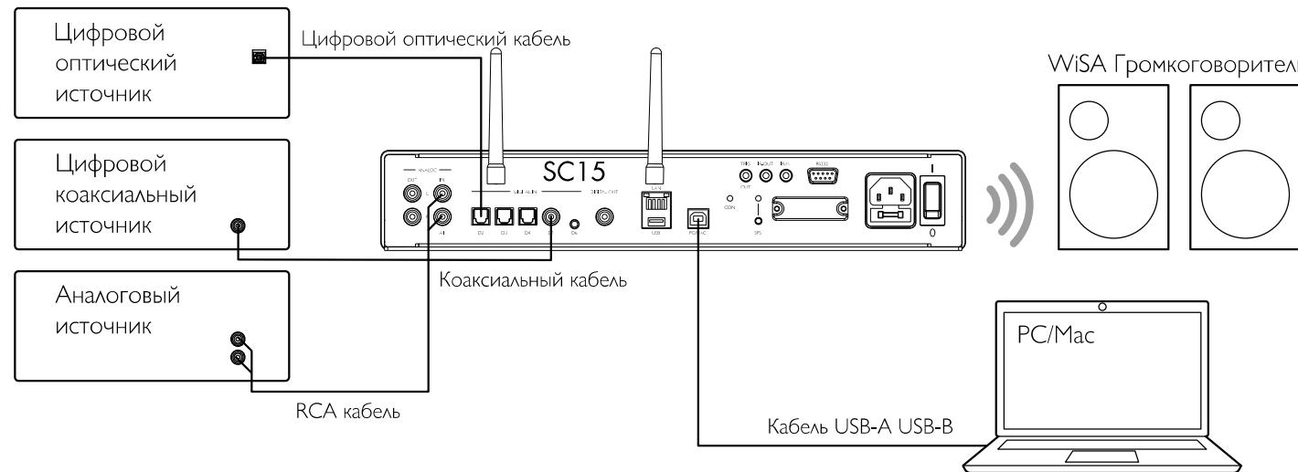
Эти способы воспроизведения музыки предусматривают подключение источника к SC15 с помощью кабеля и не требуют подключения Wi-Fi, Ethernet или Bluetooth.
