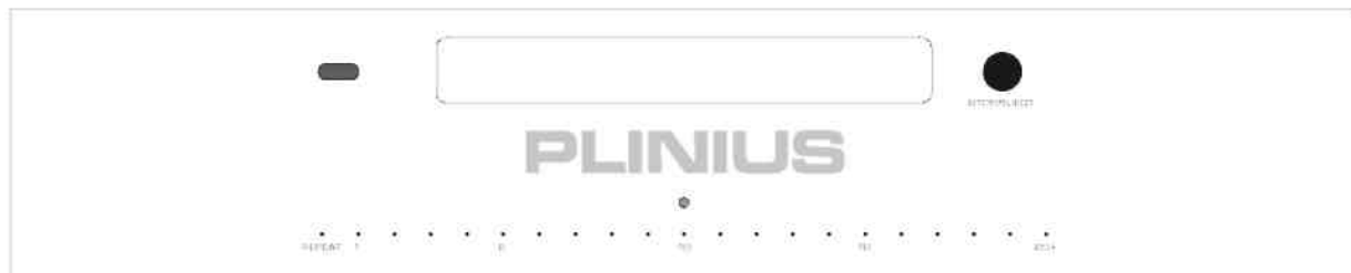
Схема передней панели проигрывателя компакт-дисков, отображающая выдвигаемое устройство для дисков, кнопку, индикаторы сети и дисплейные светодиоды
