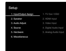
3. С помощью курсорных кнопок выберите «6.Miscellaneous» — «Firmware Update» — «Update via NET» (Прочее — Обновление ПО — Обновление по сети), затем нажмите кнопку ENTER.
