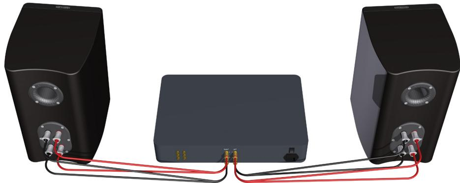
**! ПРИМЕЧАНИЕ:** В случае применения соединения этого типа необходимо УДАЛИТЬ перемычки между клеммами.
