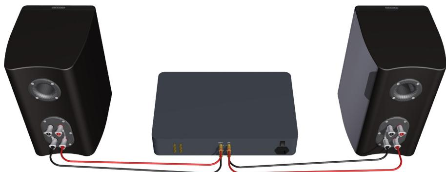
**ПРИМЕЧАНИЕ:** В случае применения соединения этого типа необходимо ОСТАВИТЬ НА МЕСТЕ перемычки между клеммами.
