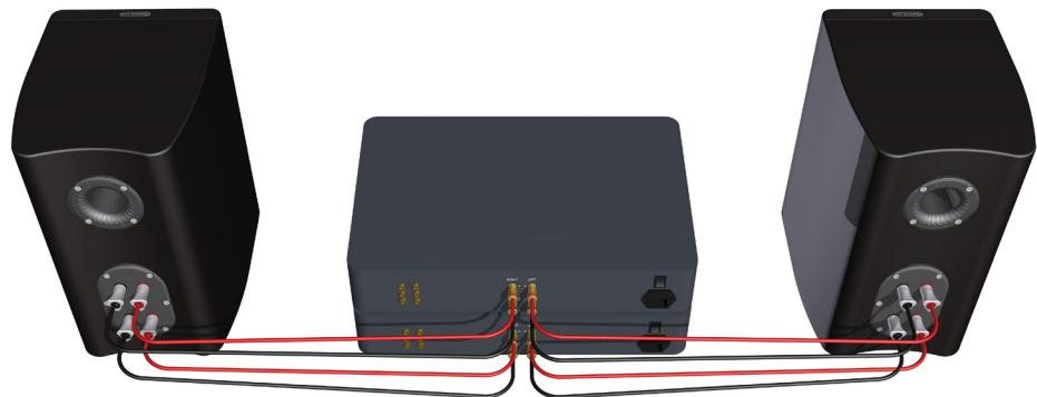
**! ПРИМЕЧАНИЕ:** В случае применения соединения этого типа необходимо УДАЛИТЬ перемычки между клеммами.
