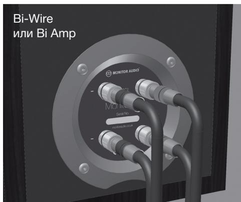
Некоторые усилители поддерживают возможность подключения по схеме Bi Amp. В этом случае каждая пара кабелей подключается к отдельной паре разъемов – как на усилителе, так и на акустической системе.
