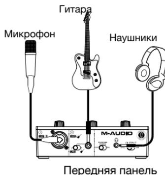
Используйте переключатель +48В (фантомное питание) только в том случае, если микрофон требует фантомного питания. Большинство динамических микрофонов и ленточных микрофонов не требуют фантомного питания, но большинство конденсаторных микрофонов требуют. Обратитесь к документации вашего микрофона, чтобы узнать нужно ли ему фантомное питание.
