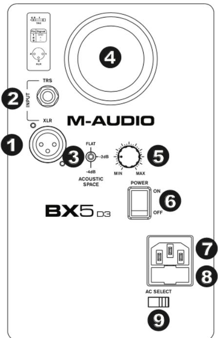
**Совет.** Убедитесь, что между задней панелью монитора и стеной оставлено не менее 3 дюймов, чтобы тыловой фазоинвертор “дышал” должным образом. Расположение монитора ближе 3 дюймов может отрицательно повлиять на воспроизведение низкочастотных сигналов.
