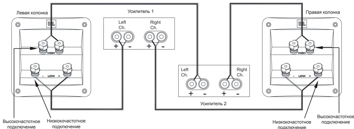
В каждом случае следуйте инструкциям для разных типов соединений в п. «Основное однопроводное подключение» на стр. 4. Примечание. Для получения более подробной информации о различных вариантах выполнения проводных соединений и подключений колонок свяжитесь с местным дилером JBL.
