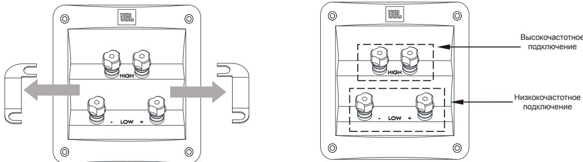
Контактный узел 4349 имеет два набора входных клемм, объединенных перемычками. Верхний набор клемм предназначен для подключения компрессионного динамика, а нижний набор — для НЧ-динамика (вуфера).
