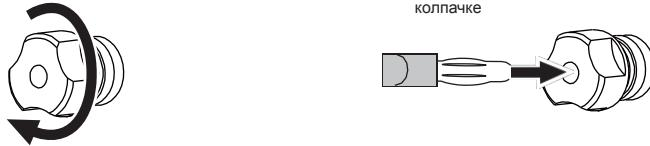
**ВНИМАНИЕ!** Обязательно затяните колпачки с тем, чтобы перемычки хорошо удерживались между соответствующими клеммами. Если перемычки ослабли, работа динамиков будет нарушена.
