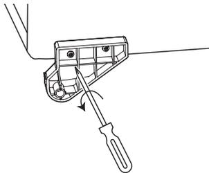
2. Вставьте чёрные внутренние опоры во внешние (расположенные спереди для передних опор, и сзади – для задних) отверстия, из которых вы только что вынули опоры, воспользовавшись теми же болтами.
