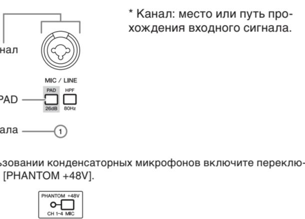
**ПРИМЕЧАНИЕ** При использовании конденсаторных микрофонов включите переключатель (—) [PHANTOM +48V].
