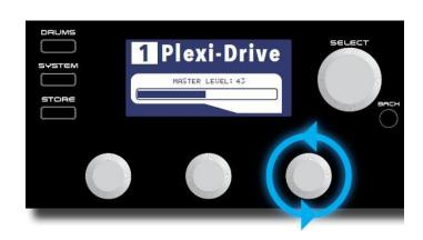
**ПРИМЕЧАНИЕ**. Изменение параметров уровней громкости влияет на уровень сигнала, поступающего на все выходные разъёмы процессора.
