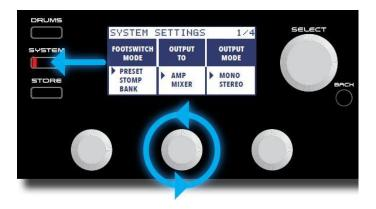
оптимизацию выходного сигнала процессора для подключения к соответствующим типам звукоусислительного оборудования. Этот параметр может быть изменён только при подключении процессора через выходные разъёмы LEFT OUTи RIGHT OUT.
