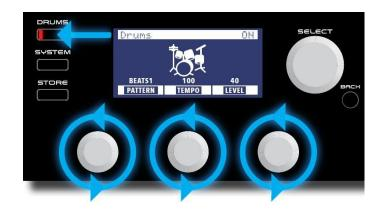
**ПРИМЕЧАНИЕ.** Драм-машина и лупер не могут использоваться одновременно. Если была сделана запись с использованием лупера, то, прежде чем включить драм-машину, необходимо очистить сделанную запись. Чтобы стереть луп, сначала остановите воспроизведение двойным нажатием на ножной переключатель 3, затем снова нажмите на него и удерживайте около 2-х секунд.
