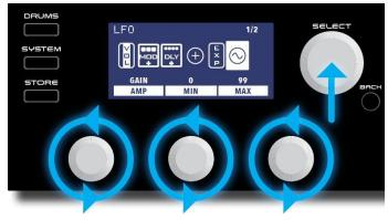
скоростью. При его настройке, кроме самого параметра и его минимального и максимального значений, вы можете выбрать форму волны и скорость. Подробности о назначении управляемых параметров и их список в разделе "Параметры, назначаемые на педаль экспрессии и LFO".
