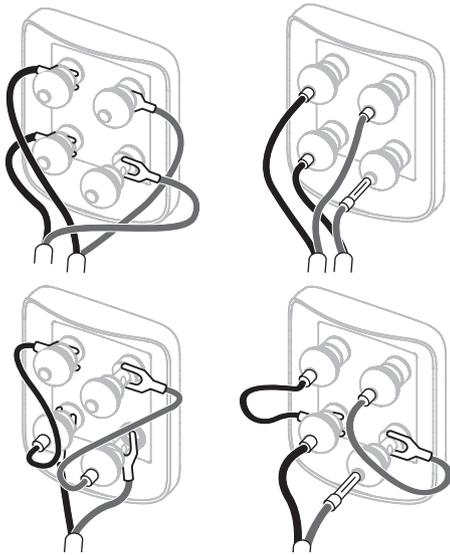
En la parte posterior de la caja acústica hay dos pares de terminales de conexión para facilitar el bicableado (arriba). Para realizar una conexión convencional en monocableado, coloque los puentes suministrados de serie de tal modo que los terminales positivos y los terminales negativos estén unidos entre sí (es decir, positivo a positivo y negativo a negativo).
