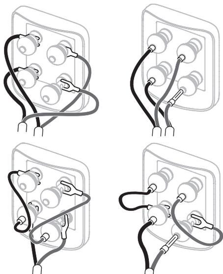
各スピーカーの背面には、バイ・ワイヤリングが可能な2組の端子があります(トップ図参照)。従来のシングル・ワイヤ接続を行う場合は、付属のリンク・ワイヤで同じ極性の端子をつないでください。
