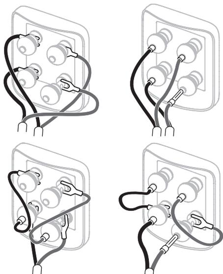
На задней панели колонок имеются по две пары клемм, чтобы обеспечить возможность подключения би-ваерингом (двухкабельное, bi-wiring, см. рисунок выше). Для обычного, однокабельного подключения, подсоедините проводники к клеммам соответствующей полярности.
