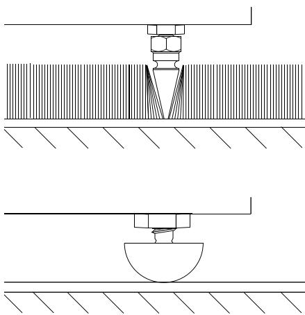
DB1可使用橡胶或钉脚进行安装，配件包中均备有。我们建议尽可能使用钉脚。钉脚是专为穿过地毯并站稳在地板上而设，同时保护地毯不留压痕，且为超低音提供固定的基座。
