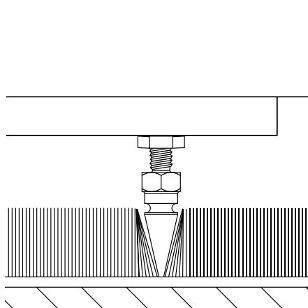
Una volta che il piedino a punta o in gomma è inserito, il DB1 può essere riportato in posizione originale. Fate attenzione a non caricare tutto il peso del subwoofer su di un solo angolo su di uno o due piedini quando lo girate. Tenete presente inoltre che maneggiando il subwoofer con poca attenzione potreste ferirvi con i piedini a punta.
