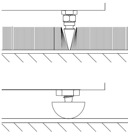
DB1は、ゴム脚(付属品)またはスパイク脚(付属品)で取り付けることができますが、スパイク脚を使用することをお勧めします。スパイク脚はカーペットに刺さることで、その下の床にDB1が据え付けられるように設計されており、カーペットを部分的に押しつぶすことなく、サブウーファーをしっかりと安定させることができます。
