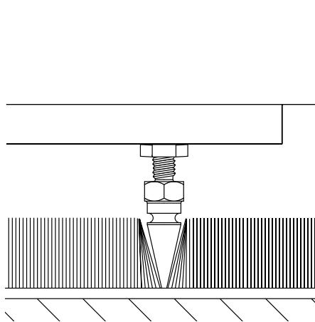
Una vez que los pies de goma o metálicos han sido instalados, el DB1 puede volver a ser colocado en su posición normal (es decir descansando sobre dichos pies). En el momento de dar la vuelta al subwoofer, procure que la totalidad del peso del mismo no descance nunca sobre uno o dos de sus pies. Asimismo, sea muy cuidadoso a la hora de manejar el subwoofer con las puntas metálicas ya instaladas para evitar que puedan dañarle.
