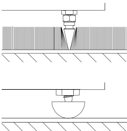
Sul DB1 possono essere utilizzati piedini in gomma o a punta – entrambi forniti in dotazione. E' consigliabile utilizzare i piedini a punta quando possibile. I piedini a punta sono progettati per perforare il tappeto e poggiare sul pavimento sottostante.
