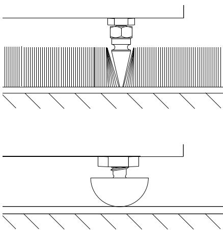
DB1 можно установить на шипы или резиновые опоры – те и другие прилагаются в комплекте. Мы рекомендуем использовать шипы всюду, где это возможно. Шипы протыкают ковер и обеспечивают прочную опору сабвуфера о пол без повреждения ворса ковра.
