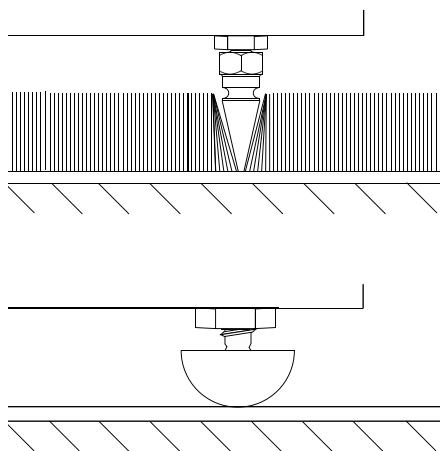
De DB1 kan worden voorzien van zowel rubber voetjes als spikes – beide vindt u bij de toebehoren. Wij raden aan indien enigszins mogelijk spikes te gebruiken. De spikes zijn bedoeld om door het tapijt heen te prikkelen zodat de subwoofer stevig op de onderliggende vloer staat en in het tapijt geen afdruk achterlaat.
