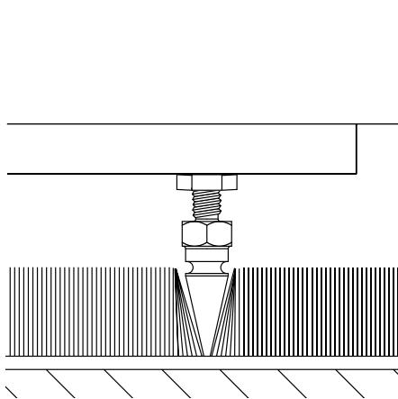
一旦安装好钉脚或橡胶脚，便可将DB1放回在底脚上。请注意，在倒转时，不要将超低音的整个重量集中在一或两个钉脚上。同时请注意，不小心处理安装超低音底脚并不要造成损伤。
