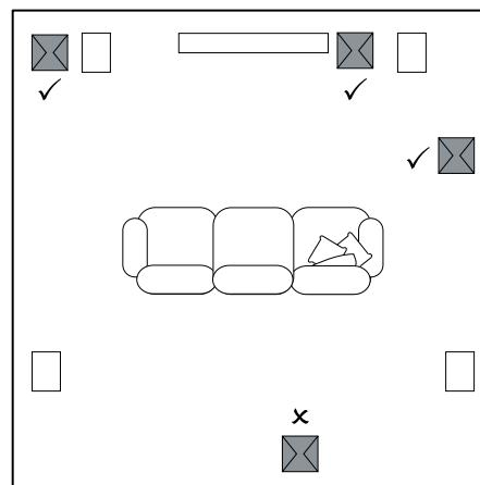
El DB1 puede colocarse directamente sobre el suelo o ser instalado en el interior de un mueble hecho a medida.
