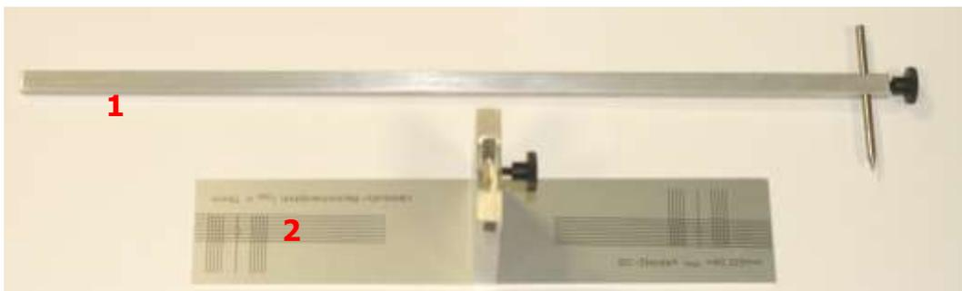
1. Aluminiumlineal mit vormontiertem Einstellhorn und Inbusschlüssel (nicht abgebildet)
