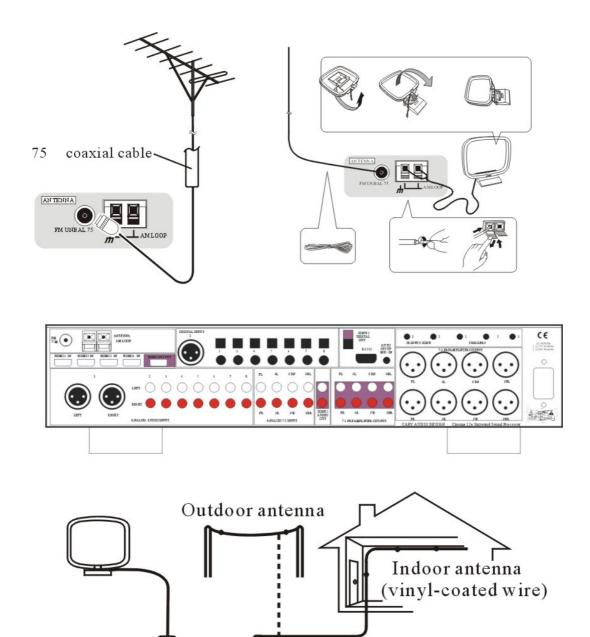
Для улучшения приема AM подключите провод с виниловым покрытием длиной от 15 до 18 футов к терминалам AM LOOP без отключения прилагающейся AM антенны. Для достижения наилучшего приема вывесите его горизонтально вне помещения.
