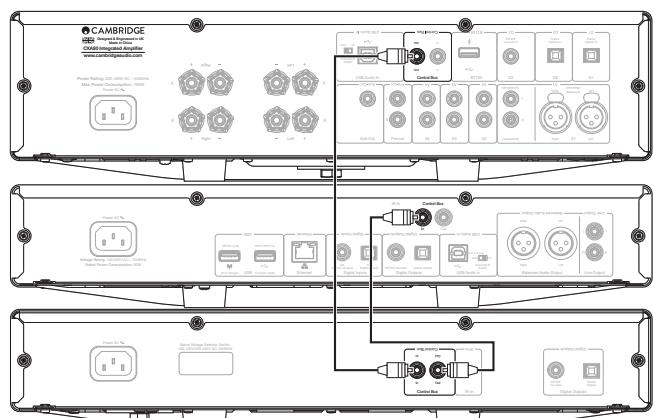
Выполнение дополнительного подключения от CXN к CXA приведет к включению использования функции Cambridge Connect app.
