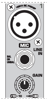
Рис. 2.1: Соединительные элементы и регулятор Mic-/Line-входов
