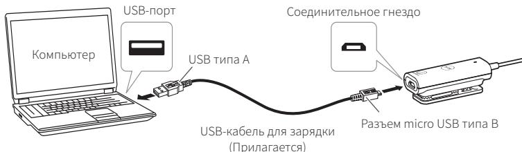
2. Подсоедините прилагаемый USB-кабель для зарядки (разъем USB типа A) к компьютеру, чтобы начать зарядку.
