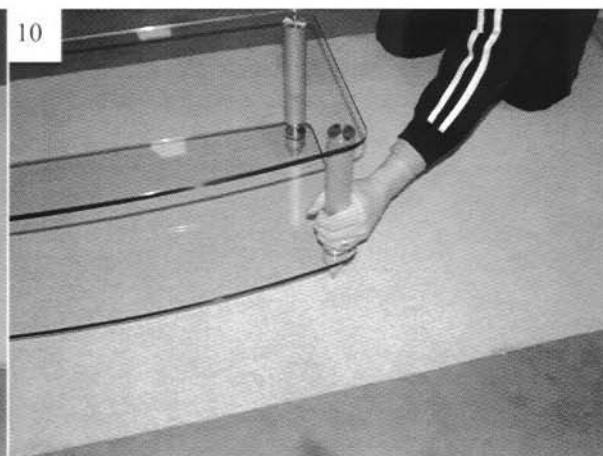
Убедитесь, что конусы надёжно закреплены в углублениях фиксирующих шайб, прежде чем вручную затянуть конструкцию, как показано на рисунке.
