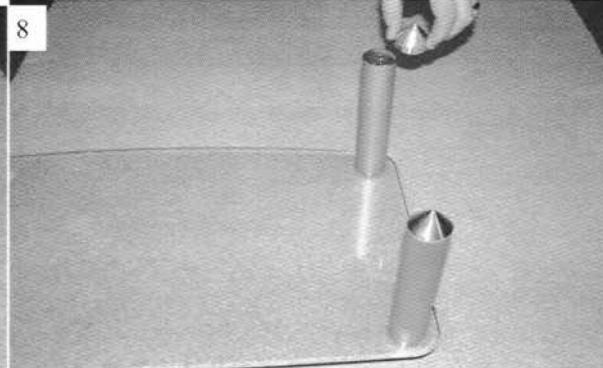
На каждый из четырёх штифтов установите трубчатую опору, после чего на штифт вручную навинтите металлический конус для фиксации опоры. **НЕ ЗАТЯГИВАЙТЕ СОЕДИНЕНИЕ СЛИШКОМ СИЛЬНО!**
