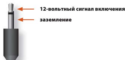
Триггерный вход активен только при нажатой кнопке включения питания на передней панели. В обычном режиме к этому входу ничего подключать не нужно.
