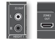
Разъем HDMI Z2 out может использоваться для подключения выходного разъема ресивера AVR850/AVR550/SR250 к системе, расположенной во втором помещении.
