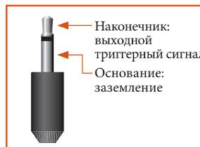
Триггерные разъемы (TRIG Z1 и TRIG Z2) подают электрический сигнал, когда ресивер AVR850/AVR550/SR250 включен, а также когда включены соответствующие зоны.
