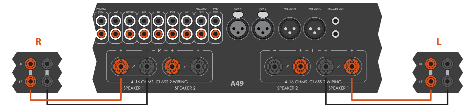
Un A49 collegato agli altoparlanti con cablaggio singolo.
