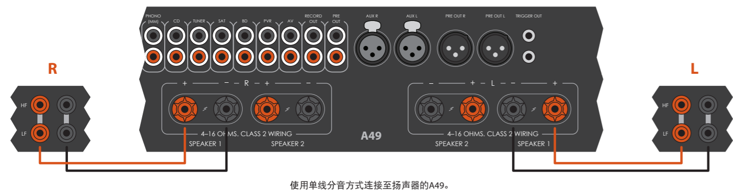
使用单线分音方式连接至扬声器的A49。
