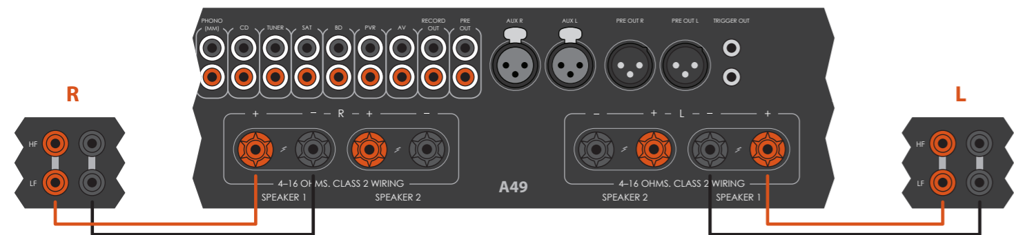
Un A49 conectado a los altavoces usando cableado individual.
