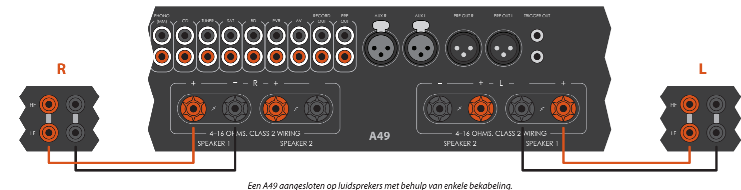
Een A49 aangesloten op luidsprekers met behulp van enkele bekabeling.
