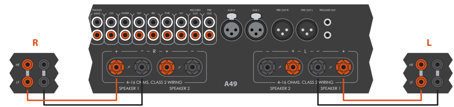
Der A49 mit Einzelverdrahtung der Lautsprecher.
