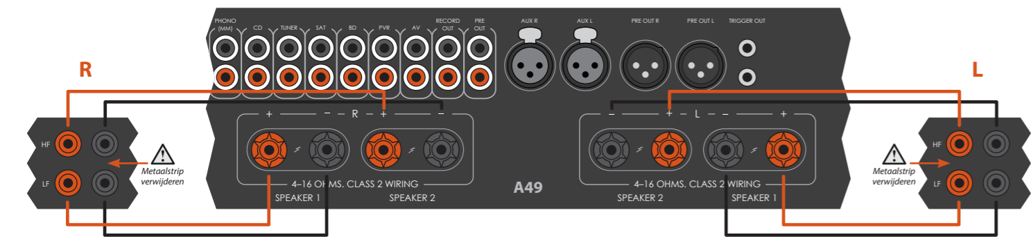
Een A49 aangesloten op twee sets luidsprekers met gebruik van bi-bedrading.
