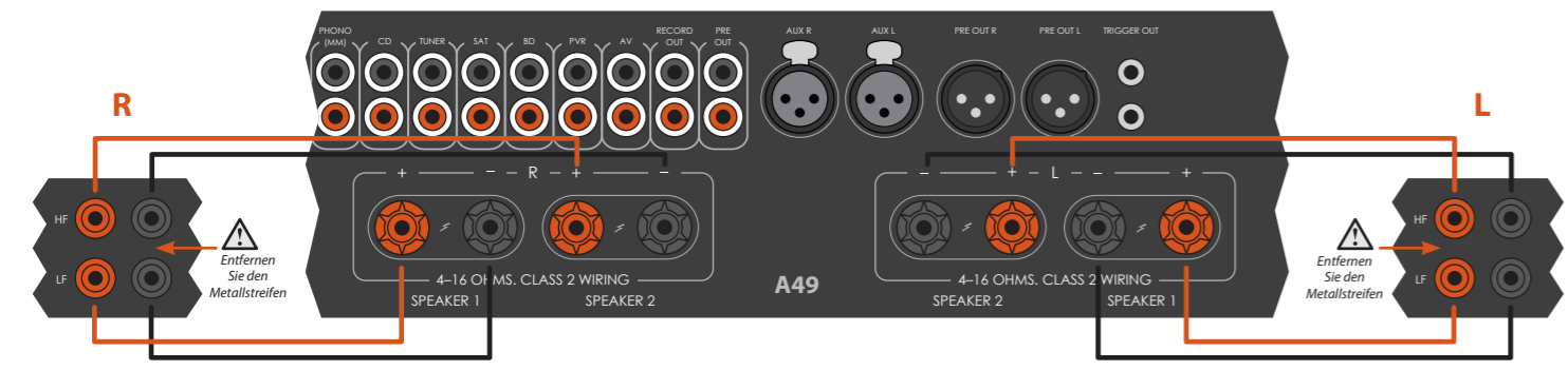
Der A49 mit Doppelverdrahtung von zwei Lautsprechergruppen.
