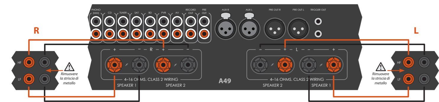
Un A49 collegato a due set di altoparlanti utilizzando un doppio cablaggio.
