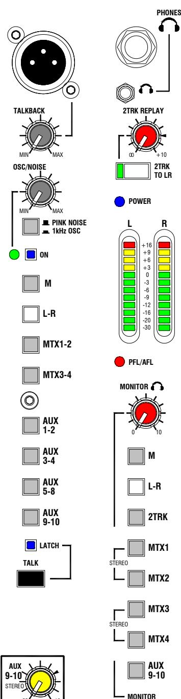
**Переговорное устройство TALKBACK** Переговорное устройство можно индивидуально назначить на все главные выходы. Подключите подходящий кабель или микрофон на "гусиной шее". Рекомендуется динамический или конденсаторный микрофон хорошего качества. Заметьте, что имеется возможность подачи фантомного питания +48V. По желанию эта возможность может быть заблокирована переключением внутренней перемычки.
