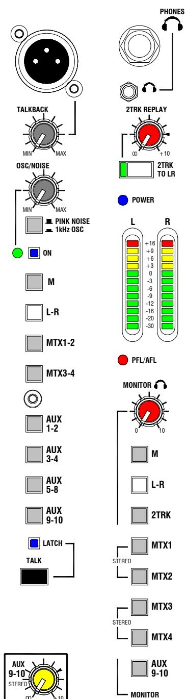
**2TRK REPLAY** Любой стерео источник, например CD-проигрыватель, можно направить напрямую в главный LR-микс. Поворотный регулятор меняет уровнем сигнала от "полностью выключен" до усиления +10dB. Вы можете проконтролировать источник на шкале индикации и в наушниках нажатием кнопки 2TRK перед тем, как направить его в микс.
