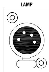
**ГНЕЗДО ДЛЯ ЛАМПЫ LAMP** Пульт имеет два 4-х штырьковых XLR гнезда для подключения стандартной 12-ти вольтовой лампы на гусиной шее для освещения рабочего пространства во время работы в темных местах. Мы рекомендуем лампу Allen & Heath LEDlamp с холодным белым светом.
