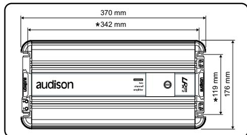
\* Quote di foratura per il fissaggio
