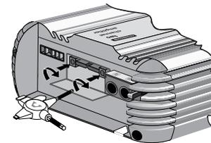
3 - Verificare il valore del nuovo fusibile da inserire, quindi fissarlo serrando gradualmente e alternatamente le due viti. Ciò eviterà cadute di tensione lungo la linea e agevolerà il perfetto funzionamento del dispositivo.
