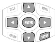
Touches fléchées: Précédent (◀), Suivant(▶), Confirme la sélection (ENTER), fait défiler vers l'avant (▲), fait défiler vers l'arrière (▼).
