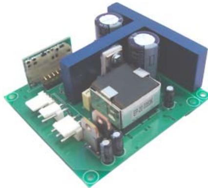
Das UcD 400 ist ein Vollbereichs-Digital-Endstufenmodul in sehr leichter Bauweise Und einer leistung von 400 Watt. Das Modul verfügt über einen Remote Eingang zur automatischen Aktivierung. Seine Einsatzbereiche erstrecken sich über z.B.: aktive Monitore, High End Mehrweg-Aktivlautsprecher, kleinere PA-Systeme, aktive Subwoofer und sonstige DIY Projekte. Einen kleinen Bruder stellt das UcD 180 mit 180 Watt Ausgangsleistung !
