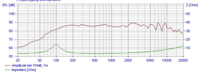
VISATON FR 10 - 4 Ohm Frequenzgang und Impedanz
