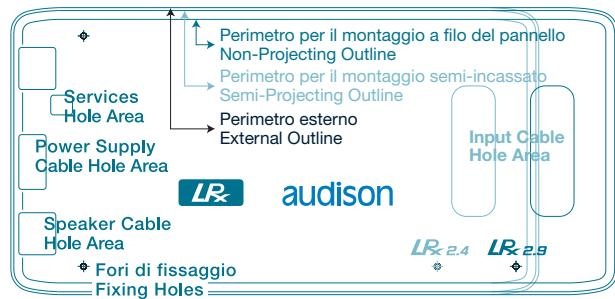
В комплект входит шаблон, способствующий предварительному планированию для монтажа усилителя. На шаблоне напечатаны инструкции для полу-утопленного монтажа, или для монтажа на плоской поверхности. Если Вы хотите спрятать кабели, см. соответствующие отверстия на шаблоне.
